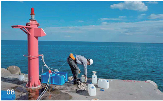
[01] 福島第一原子力発電所沖で観測する東京海洋大学海鷹丸 [02] 海水を表層から海底直上まで任意の深さで採取してきた採水器を回収 [03] 採取した海水を船上で容器に分取 [04] 生物試料を採取した網を回収 [05] 採取した生物試料の放射能検査 [06] 採取した生物試料を実験室で種類に分ける作業 [07] 採取された海底堆積物 [08] 福島県富岡での表面海水採水作業
