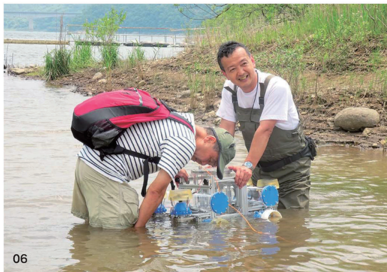
[01]湖畔での水中ロボットの組み立て作業 [02・07]放射性ストロンチウムの迅速分析のためのICP-MS装置の調整作業の様子 [03]可搬型γ線スペクトルメータを用いた放射性核種の屋外マッピング作業の様子 [04]土壌に含まれる鉱物(光学顕微鏡と透過型電子顕微鏡による観察) [05]土壌採取用の水中ロボットの全景 [06]湖での水中ロボットの試運転の様子 [08]放射性ストロンチウムの迅速分析技術に関するプレスリリース
