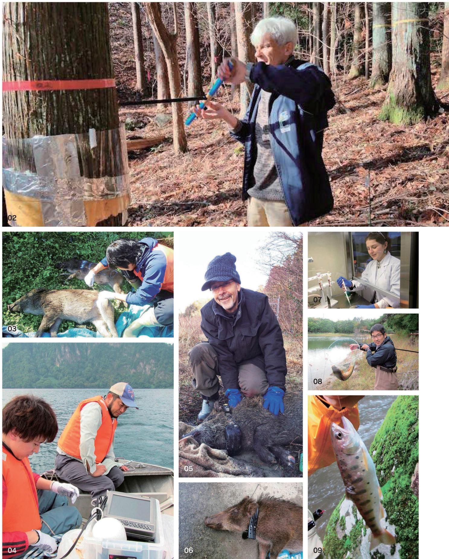
[01] 福島の豊かな自然、森林と溪流 [02] 成長錐で木のコアを採集 [03] イノシシの生体検査 [04] 魚類への移行経路解明のための沼沢湖の放射性物質分布調査 [05・06] GPS・線量計内蔵の首輪を装着したイノシシの行動と被ばく線量の調査 [07] 微生物群集構造を調べる分子生物学的操作 [08] 大熊町貯水池における魚類調査 [09] 葛尾川におけるヤマメ釣獲調査
