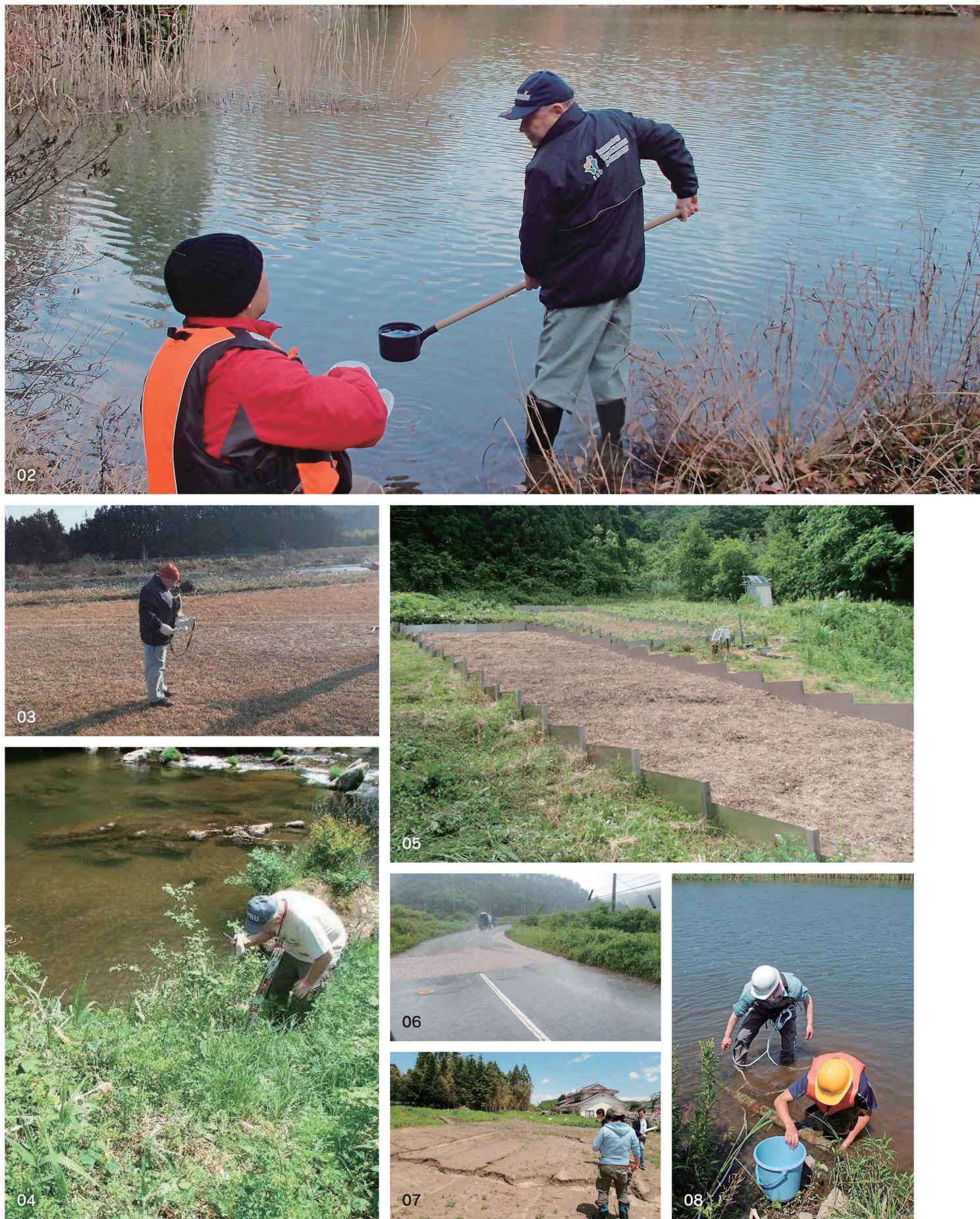
[01] 水没地での調査の様子 [02] 湖沼でのサンプリングの様子 [03] 親水公園での調査の様子 [04] 河川での調査の様子 [05] 斜面での土砂と放射性物質の移動量を観測するための施設(土壤侵食プロット) [06] 豪雨時に流出する水と土砂 [07] 降雨によって侵食された除染地の様子 [08] 河川における土砂サンプル採取の様子
