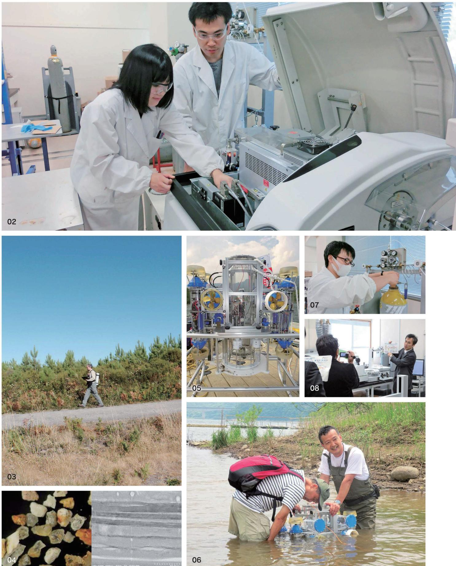
[01]湖畔での水中ロボットの組み立て作業 [02・07]放射性ストロンチウムの迅速分析のためのICP-MS装置の調整作業の様子 [03]可搬型γ線スペクトルメータを用いた放射性核種の屋外マッピング作業の様子 [04]土壤中に含まれる鉱物(光学顕微鏡と透過型電子顕微鏡による観察) [05]土壤採取用の水中ロボットの全景 [06]湖での水中ロボットの試運転の様子 [08]放射性ストロンチウムの迅速分析技術に関するプレスリース
