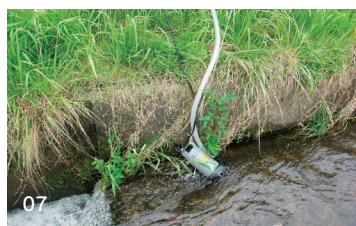
[01] 飯館村の長泥農業用ため池におけるサンプリング [02] 懸濁物質を採取するための高速連続遠心分離装置 [03] 試料の有機物分解抽出 [04] 南相馬市太田での農業用水中懸濁物質の採取 [05] ポット栽培による土壌・水からイネへの放射性セシウムの移行試験 [06] 飯館村長泥ため池のサンプリング [07] 水中ポンプによる農業用水採取 [08] 南相馬市太田地区の農業用水路
