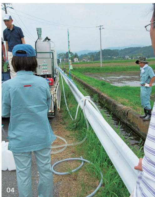
[01] 飯館村の長泥農業用ため池におけるサンプリング [02] 懸濁物質を採取するための高速連続遠心分離装置 [03] 試料の有機物分解抽出 [04] 南相馬市太田での農業用水中懸濁物質の採取 [05] ポット栽培による土壌・水からイネへの放射性セシウムの移行試験 [06] 飯館村長泥ため池のサンプリング [07] 水中ポンプによる農業用水採取 [08] 南相馬市太田地区の農業用水路
